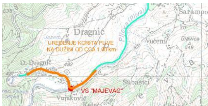
Slika 5.4.2.7.3. Dispozicija idejnog tehničkog rješenja uređenja korita rijeke Plive u dužini od 1 km u naselju Pljeva – opština Šipovo
