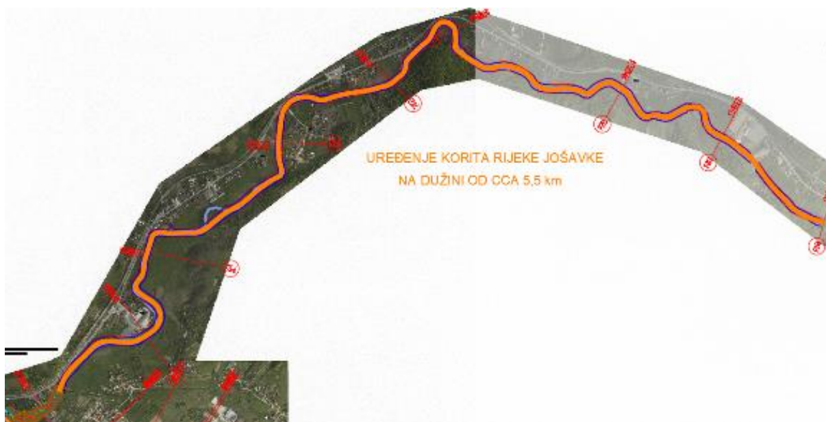
Slika 5.4.2.4.3. Dispozicija idejnog tehničkog rješenja uređenja korita r. Jošavke u Čelincu u dužini od 5,5 km
