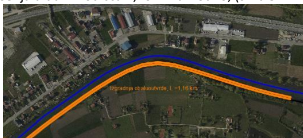
Slika 5.4.2.2.1. Dispozicija tehničkog idejnog rješenja - produženje obaloutvrde na uzvodni ptež - lokalitet Šušnjari u dužini od 1,16 km
