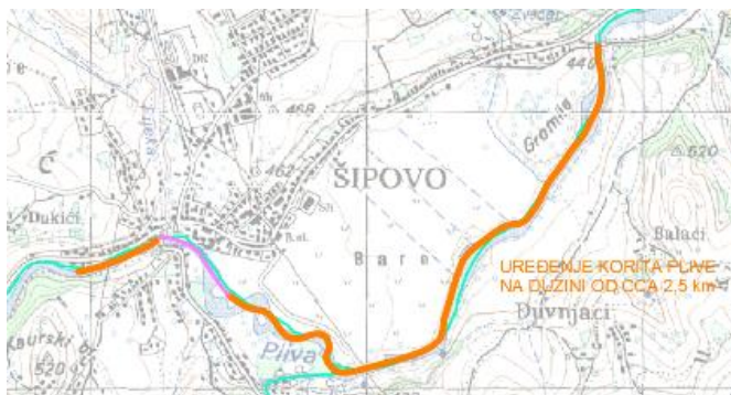
Slika 5.4.2.7.2.. Dispozicija idejnog tehničkog rješenja uređenja korita rijeke Plive u dužini od 2,5 km u užem i širem centru Šipova
