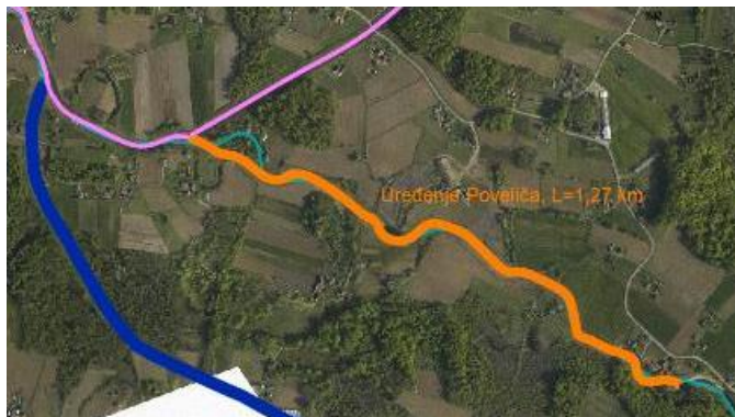
Slika 5.4.2.1.4. Dispozicija projektnog rješenja uređenja kanala Povelich od ušća Gornje Ine pa uzvodno na dužini od 1,27 km
