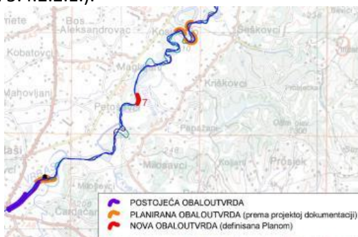
Slika 5.4.2.2.1. Situacioni prikaz lokaliteta degradirane obale glavnog korita i planirane obaloutvrde na lokalitetu „Orlović“
